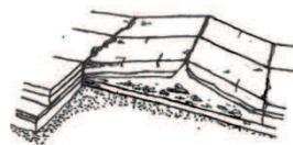
(3) Vertikale Plattenauslenkung < 5 cm ( \_\_\_\_\_ mm)
